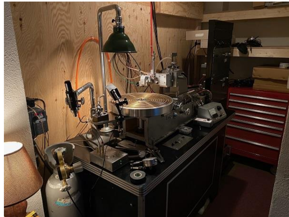
Piccolo Audio Works のカッティングマシーン WESTERN ELECTRIC RA-1389 (カッティングエンジニアの松下真也さんにより改良されている)
