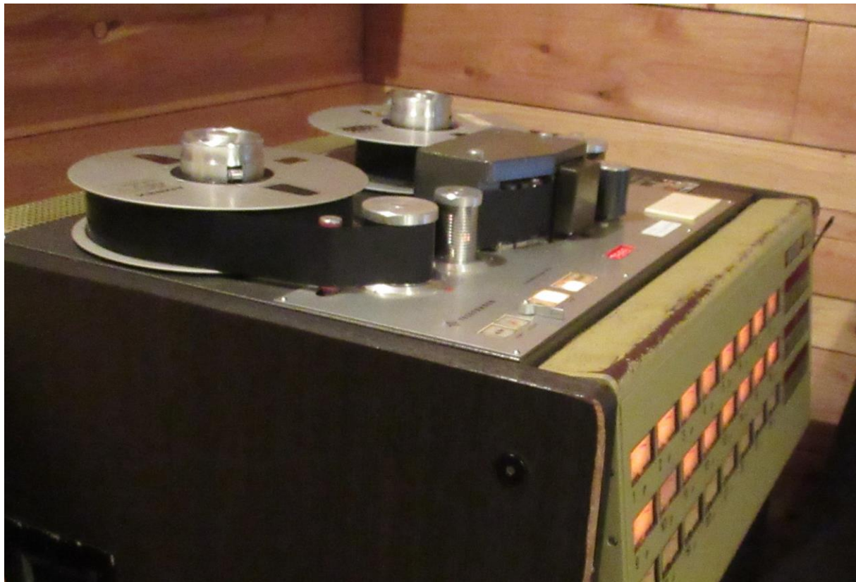
録音に使用したマルチトラックテープレコーダー (TELEFUNKEN M15 w/ 16 Track Head)
